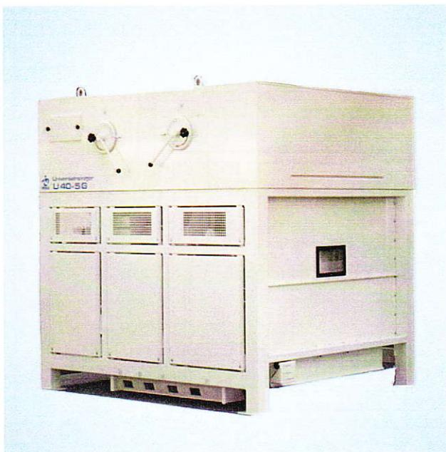
Der PETKUS-Universalreiniger ist ein kompakter Siebsichter mit 2 Siebebenen und 2 Sichtern, der als Vorreiniger, Intensivreiniger und Saatgutreiniger für Getreide eingesetzt werden kann.
